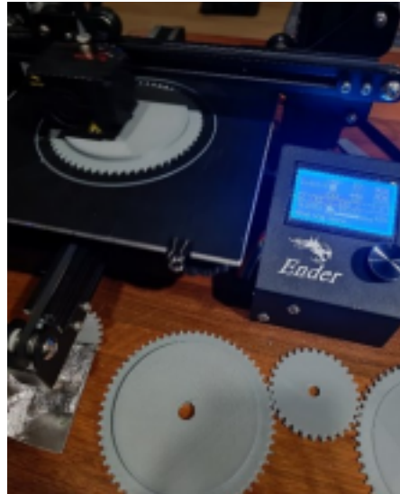
Rajah 4: Menghasilkan sproket menggunakan pencetak 3D
